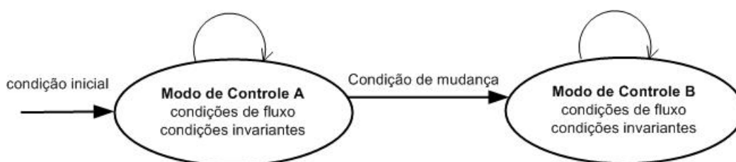
FIGURA 3.4 – Esquema geral de um autômato híbrido.
